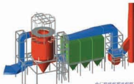
电厂脱硫装置流程图
